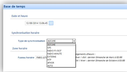
Dans le cadre d'une distribution horaire, les différents types de synchronisations permettent de définir le mode de communication entre l'horloge mère et les horloges réceptrices.
