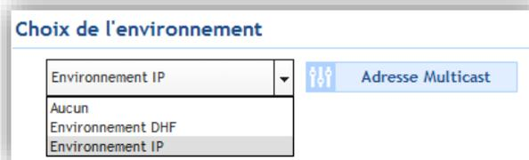
**Environnement IP** permet à l'horloge mère de piloter les équipements par réseau Ethernet.
